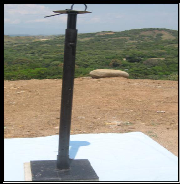
La torre contiene dos secciones: dentro del tubo principal se incrustó un tubo coaxial, de menor diámetro; esta elaboración hace posible disponer de poca longitud del mástil, para facilitar su traslado entre diversos lugares.
