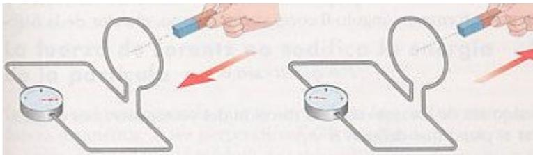
Faraday realizó el siguiente experimento. Tomó una espira metálica y un galvanómetro. Al aproximar un imán a la espira metálica observó que la aguja del galvanómetro se movía. Si no se mueve el imán, la aguja del galvanómetro marca 0 voltios. Al alejar el imán, la aguja del galvanómetro se mueve en sentido contrario, y si se separa completamente, la aguja vuelve al cero. Por ende, se concluye de que "un campo magnético en movimiento produce un flujo de corriente eléctrica". [9]
