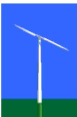
Los diseños bipala de aerogeneradores tienen la ventaja de ahorrar el coste de una pala y, por su puesto, su peso. Sin embargo, suelen tener dificultades para penetrar en el mercado, en parte porque necesitan una mayor velocidad de giro para producir la misma energía de salida. Esto supone una desventaja tanto en lo
