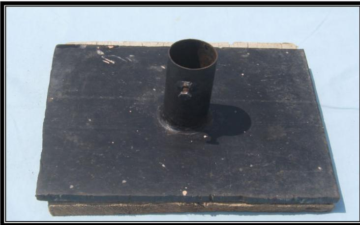
Para la construcción de este elemento, es necesario disponer de un material con suficiente resistencia que soporte el peso del prototipo; y que al mismo tiempo, mantenga estático el prototipo soportando las ráfagas de viento, que se presentan durante su operatividad. Las consultas hechas con expertos, sobre estos aspectos, permitieron seleccionar una platina de hierro de 12 Kg, con las dimensiones y forma adecuada para resistir el peso del aerogenerador.
