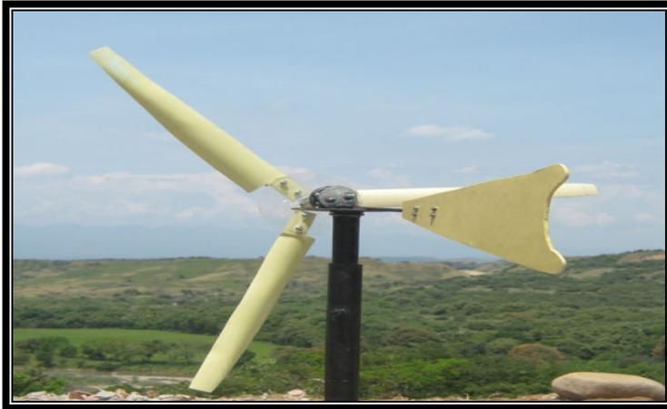
El diámetro del rotor es de 97.0 cm, esta medida es la que usan para casi todos los pequeños aerogeneradores. A mayor diámetro, menor velocidad de giro, lo que significa que el prototipo tendrá la velocidad de giro apropiada.
