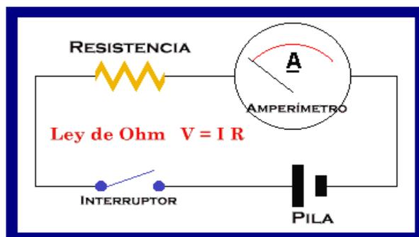
La corriente continua es un movimiento de electrones. Cuando los electrones circulan por un conductor, encuentran una cierta dificultad al moverse. A esta "dificultad" del paso de la corriente eléctrica por un conductor se le denomina Resistencia eléctrica.
