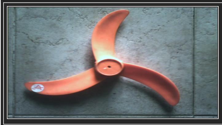
El montaje del rotor al aerogenerador presentó el problema más complicado en su instalación, ello debido a que el buje ya viene unido a las palas. Su instalación se realizó con debida la precaución, ya que un desbalance en el rotor reduciría las posibilidades de un óptimo rendimiento.
