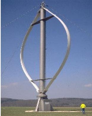
Los aerogeneradores de eje vertical son apenas capaces de mejorar la eficacia una turbina mediana de tipo hélice. La única turbina de vertical que ha sido comercialmente fabricada a todos los volúmenes es la maquina Darrieus. El diferente diseño de Darrieus tenia dos aspas de aluminio, las cuales están ensambladas por un tubo metálico por la parte inferior y superior de las aspas, esto le da un aspecto de batidora (de ahí otro de sus nombres).
