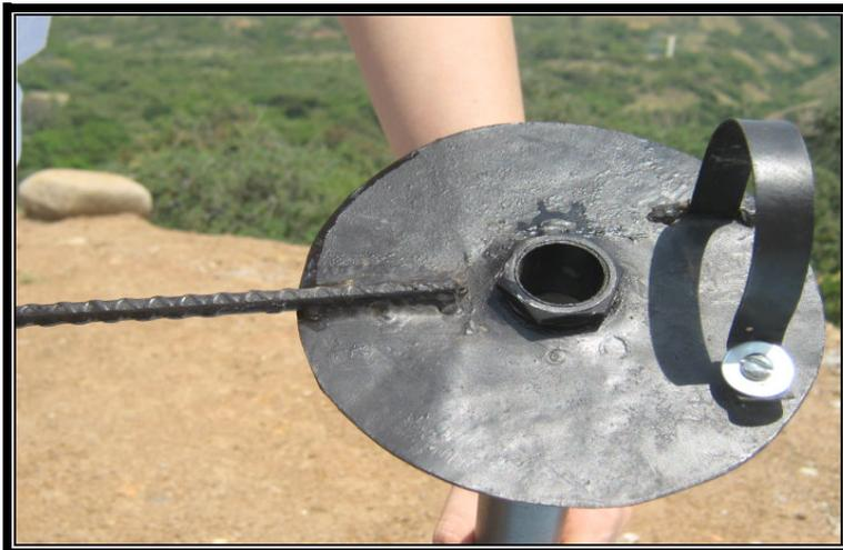
La plataforma es la base que sostiene la dinamo, la veleta y la turbina. Para la elaboración de la plataforma se cortó una platina de hierro circular, con las dimensiones adecuadas que logran aguantar el peso de los demás componentes. Posteriormente se elaboró una abrazadera para fijar la dinamo a la plataforma.
