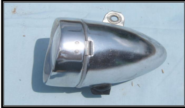
La lámpara que instalamos a nuestro prototipo es una lámpara de bicicleta antigua de 12v, conectados directamente a la batería, la lámpara nos indicará si el prototipo genera la electricidad suficiente para un óptimo rendimiento.
