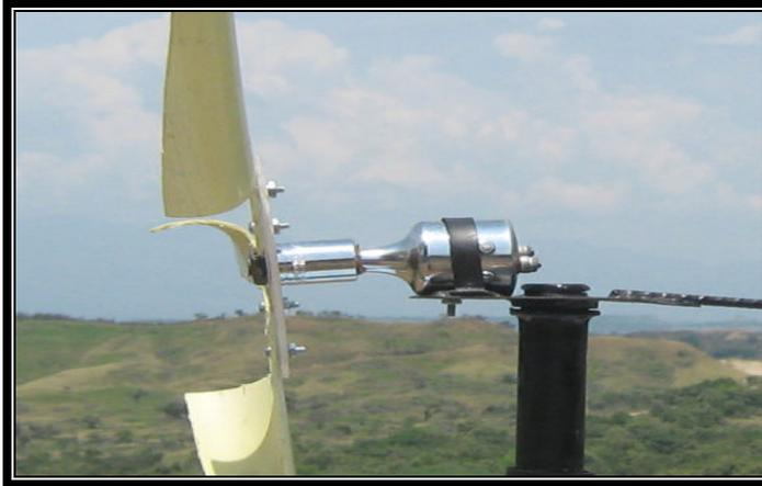
Al finalizar esta instalación, se comprobó que el rotor o turbina quedó bien ajustada, no presenta ningún tipo de desbalance. [22]
