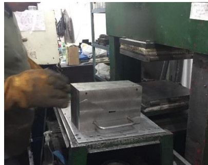
Figura 8. A. Molde de dispositivo ROL 1, B. Molde cerrado con silicona en su interior, C. Molde en prensa de vulcanizado, D. Resultado final (azul dureza 85, verde dureza 75, blanca dureza 65).
