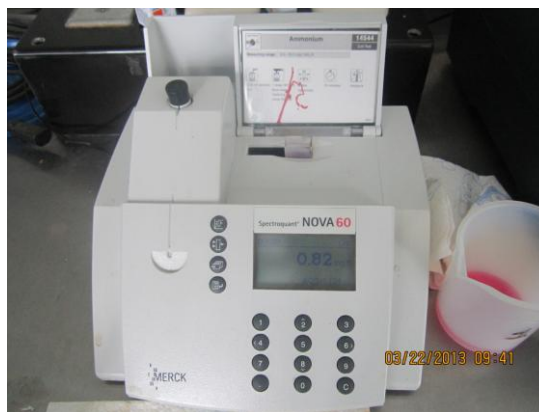
Figura 12 Colorímetro NOVA 60, MERCK.
