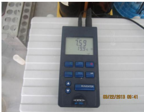
Figura 13 pH-Metro portátil 330i WTW.
