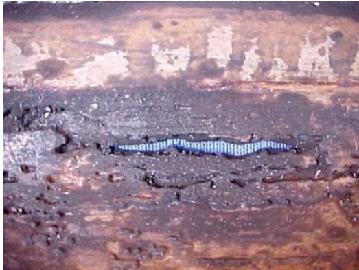
Figura 35. Superficie interna del tubing en la zona de falla.
