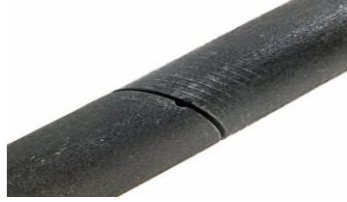
Figura 7. Ejemplo de fatiga por corrosión, por el CO 2 .
