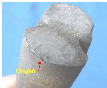
Figura 40. Origen de la grieta coincidiendo con un picado.
