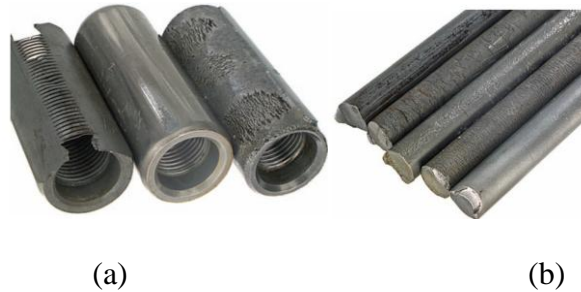
Figura 2. Ejemplos de fallas mecánicas inducidas por el diseño y las operaciones.
