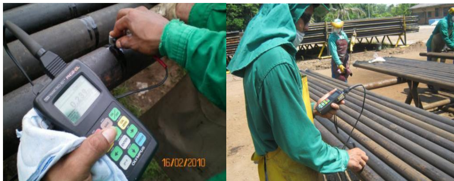
Figura 13. Inspección ultrasónica en patios de ATP Ingeniería LTDA.
