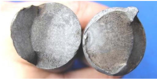
Figura 40. Origen de la grieta coincidiendo con un picado.
