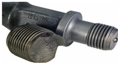
Figura 8. Ejemplo de un defecto de fresado y un defecto de maquinado.
