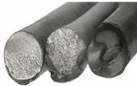
Figura 3. Ejemplo de fallas de fatiga por flexión.
