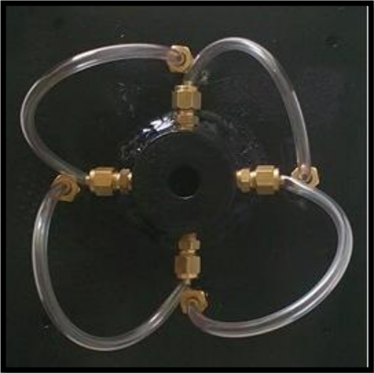
Figura 28. Distribuidor de gas Fuente: Autores
