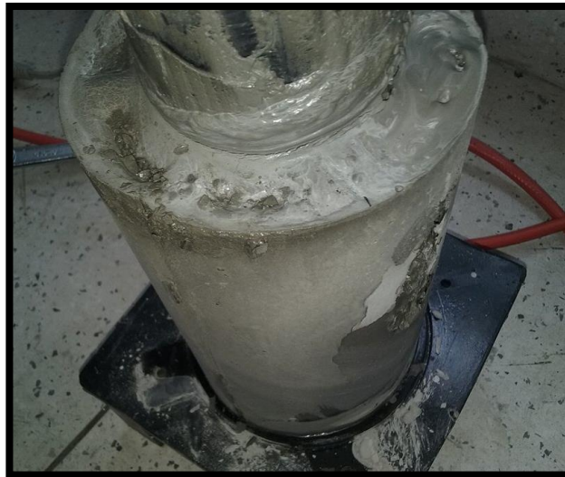
Figura 39. Espacio anular cementado prueba 2
