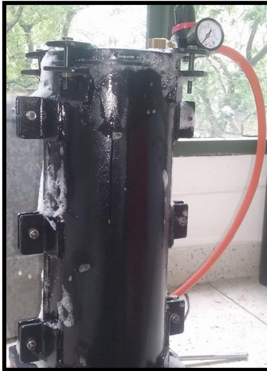
Figura 36. Prueba de hermeticidad del equipo Fuente: Autores
