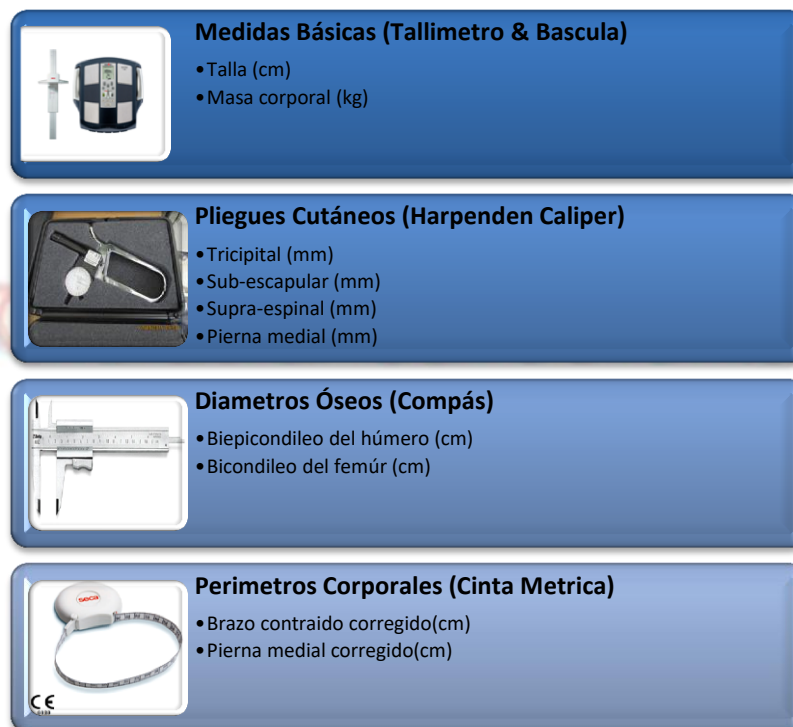
Figura 27. Medidas antropométricas e instrumentos de medición necesarios para el cálculo del somatotipo.
