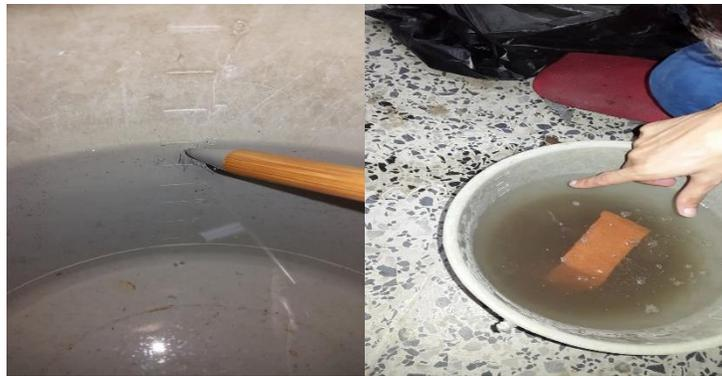
**Figura 19.** Volumen desplazado. Principio de Arquímedes.
