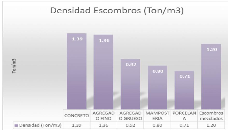
**Figura 30.** Densidad de los escombros en (Ton/ m3).
