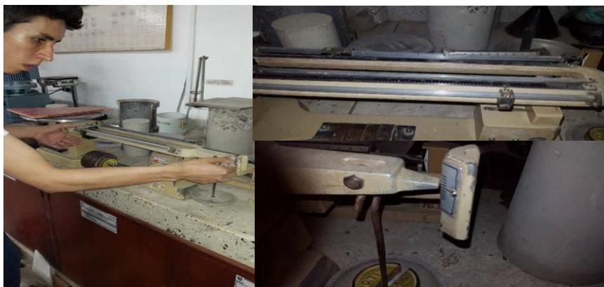
**Figura 18.** *Pesaje de muestras mediante Balanza de triple Brazo.*
