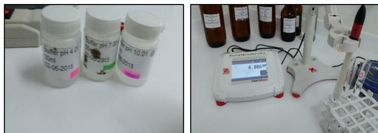
**figura 4.** Calibración del potenciómetro
