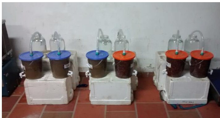
Figura 7: Montaje de fermentación anaerobia para Pulpa y Mucilago de café, ensayo de verificación a gran escala
