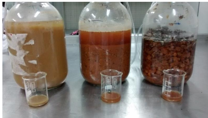
Figura 6: Montaje de fermentación anaerobia para Pulpa y Mucilago de café ensayo preliminar
