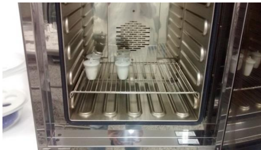
Figura 12: Montaje en estufa a 105°C durante 24 horas
