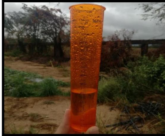
Figura 4-8. Pluviómetro
