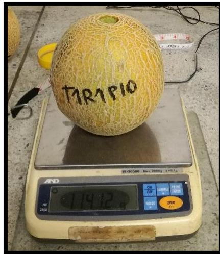
**Figura 4-12.** Balanza digital AND EK – 2000G  $\pm$  0,1 g.
