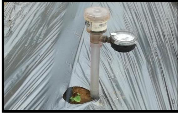
**Figura 4-9.** Tensiómetro Irrometer
