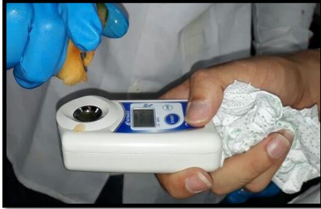
**Figura 4-13.** Refractómetro digital ATAGO Pocket PAL-1.
