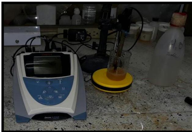
**Figura 4-14.** Potenciómetro Thermo Scientific™ Orion™ 3-Star Benchtop pH Meter.
