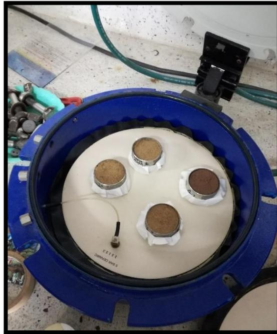
**Figura 4-4.** Olla de presión para la determinación de la curva de retención de humedad
