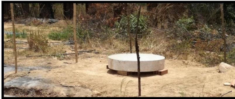
**Figura 4-7.** Tanque evaporímetro clase A.
