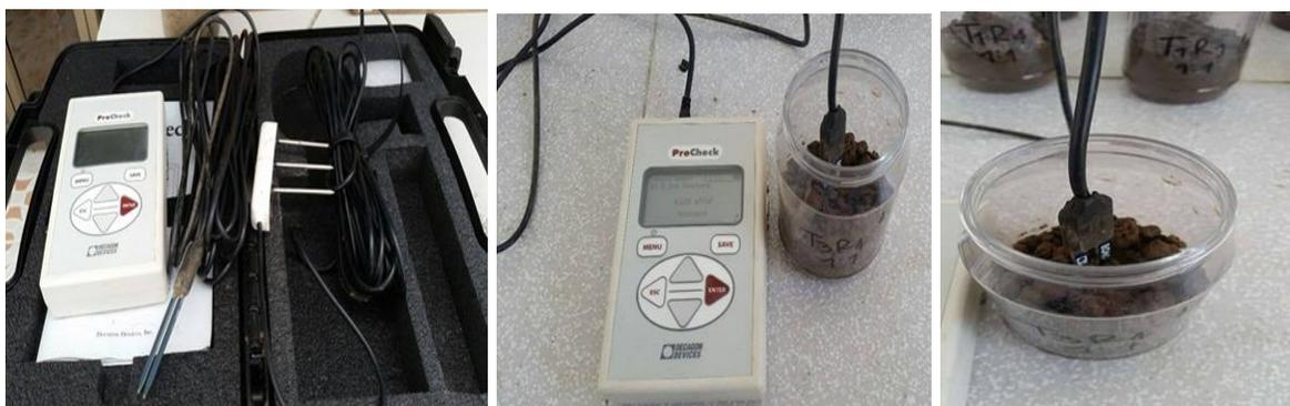
**Figura 6.** Equipo Multiparamétrico ProCheck y medición de humedades en el suelo
