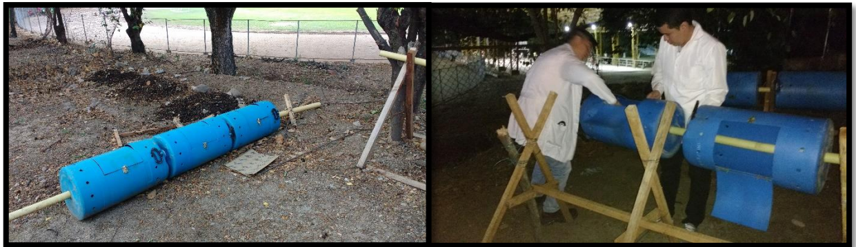
Imagen 2. Montaje de composteras.
