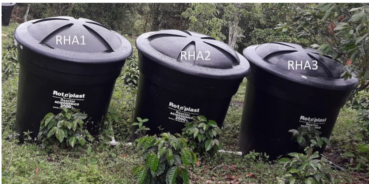
Figura 13 Reactores hidrolíticos acidogénicos
