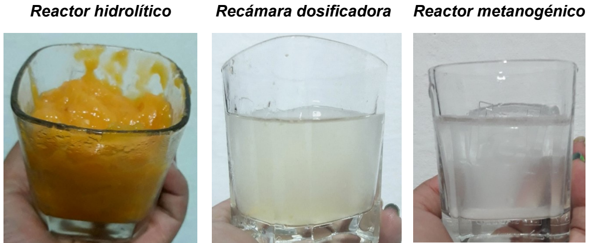
Figura 22. Cambio de tonalidad y textura del agua en las diferentes fases del SMTA.
