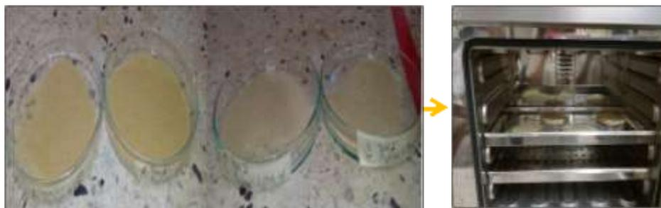
Figura 22. Determinación de humedad de la pectina A y C.
