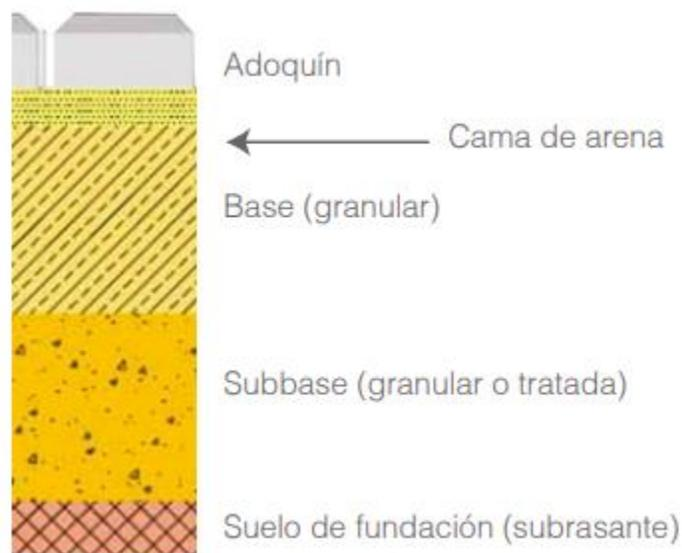
Figura 2- 3: Estructura pavimento articulado. Tomado (Instituto del cemento y del hormigón de Chile, 2013)
