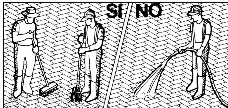
En principio, el pavimento de adoquines se debe limpiar sólo por barrido. El lavado con manguera se permitirá esporádicamente y cuando el pavimento tenga juntas muy pequeñas, advirtiéndole a los vecinos que el sello de las juntas no es suciedad, sino parte importante del pavimento y necesario para su funcionamiento.
