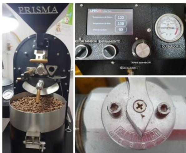
**Figura 1.** Tostador Prisma CESURCAFE, control de presión de gas y control del flujo del aire
