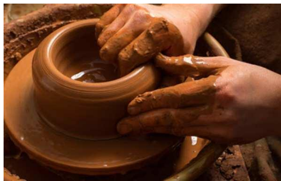
Ilustración 3. Moldeado en torno de la cerámica. Imagen (Cuariosfera-historia.com 2022)
