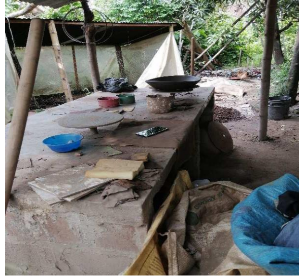
Ilustración 19. Técnicas de producción y decoración: Rollos, modelado, cilindradora y mesón de trabajo.
