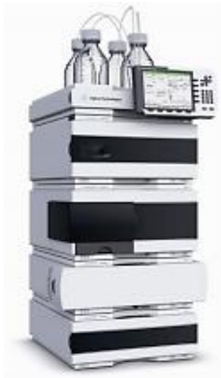
Figura No. 55 Equipo HPLC con arreglo de diodos (Garcia & Yusá, 2016)
