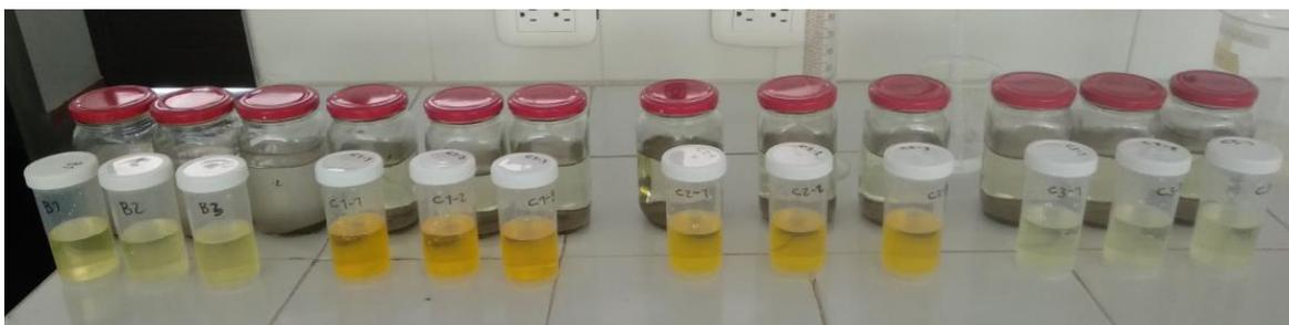
**Ilustración 2-13** Resultados colorimetría. Tratamientos con EDTA disódico di hidrato – La intensidad del amarillo es proporcional al fosfato disuelto.
