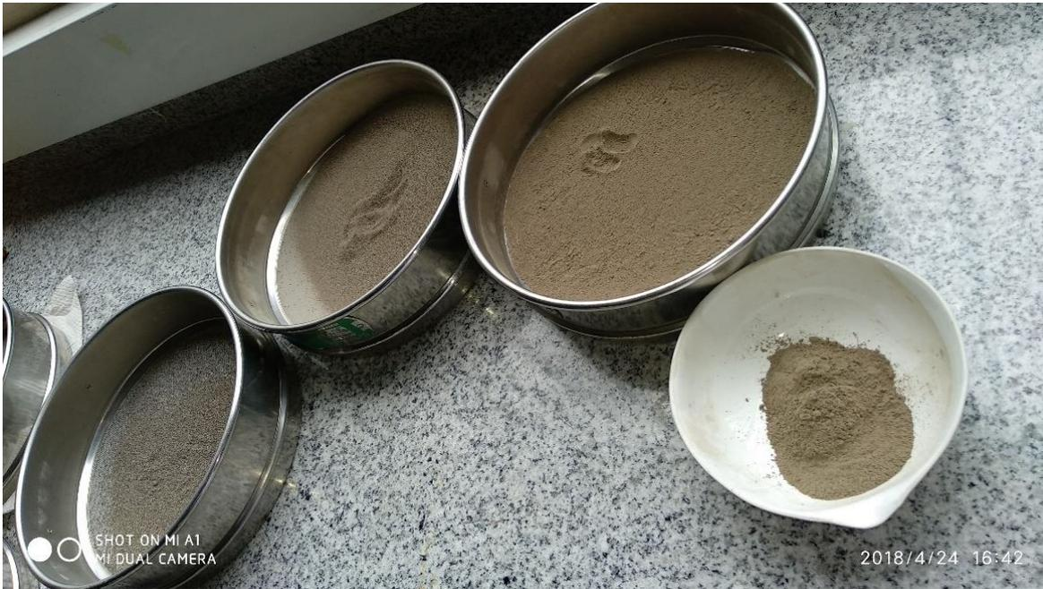
**Ilustración A 42.** Tamizado de la RF.
