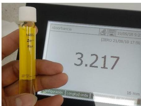
**Ilustración A 37.** Lectura de absorbancia en el espectroscopio
