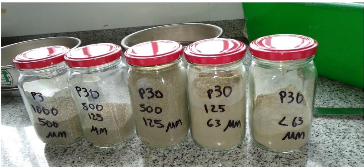
**Ilustración A 43.** Clasificación de las fracciones de la RF.
