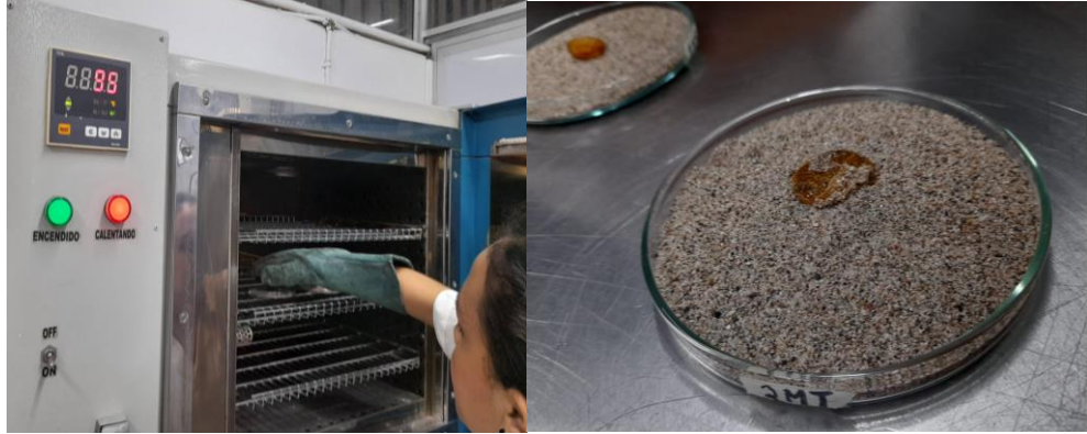
Figura 3. Gomas obtenidas en prueba N°1 sometidas a desecación en horno de convección.
