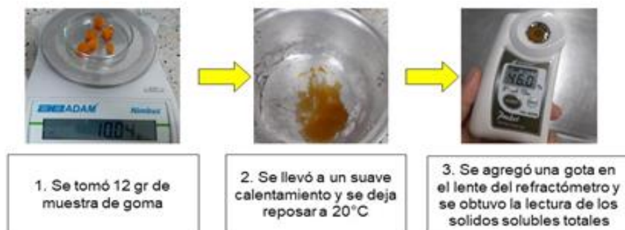
Figura 11. Procedimiento de medición de sólidos solubles totales (SST).
