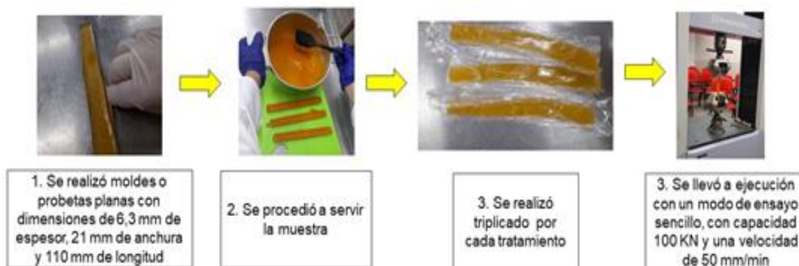
Figura 13. Procedimiento prueba de tracción.
