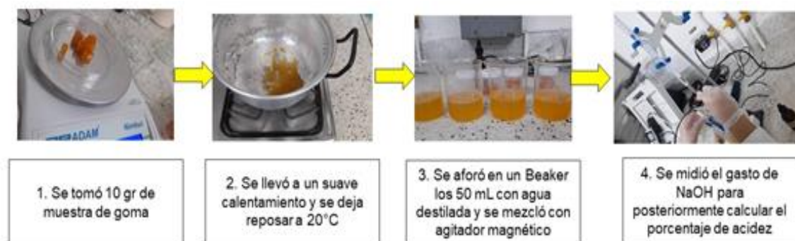
Figura 10. Procedimiento medición de acidez titulable.
