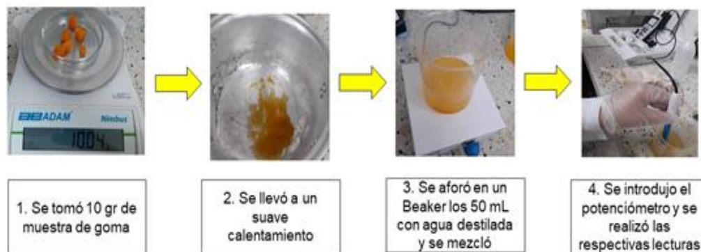
Figura 8. Procedimiento para medición de pH.
