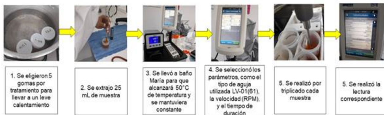
Figura 14. Procedimiento prueba de viscosidad.
