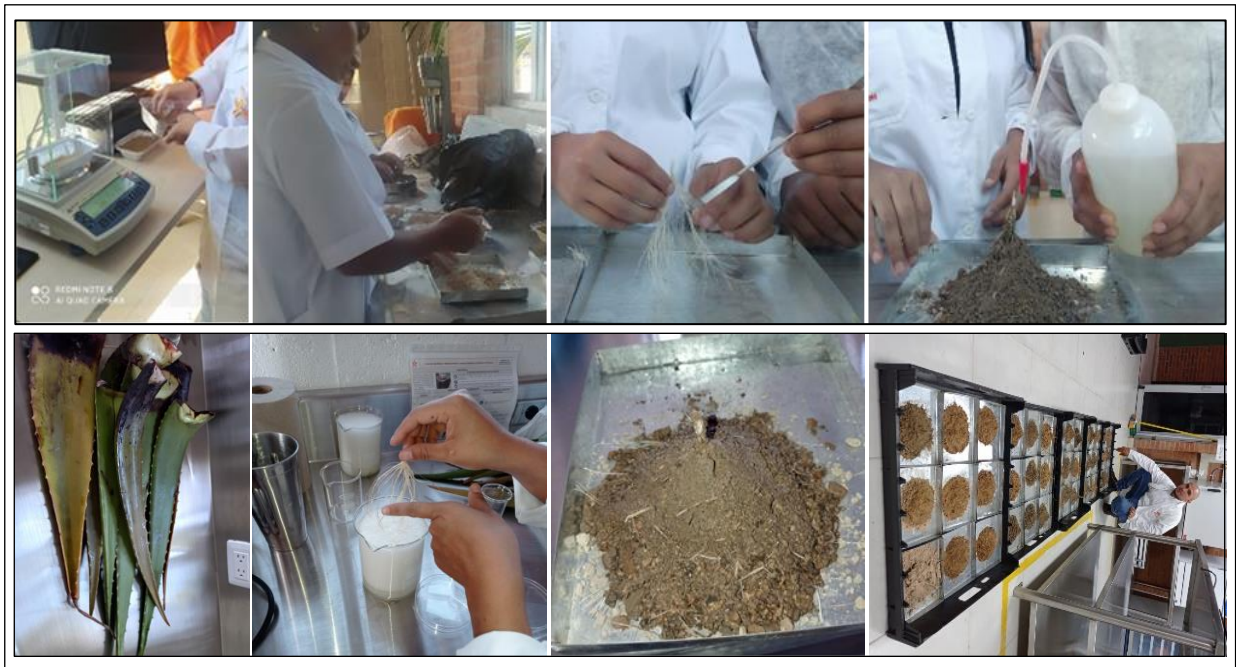
Figura 5. Construcción de las unidades experimentales en muestras de suelo, con mucílago y arquitecturas de raíz artificial.
