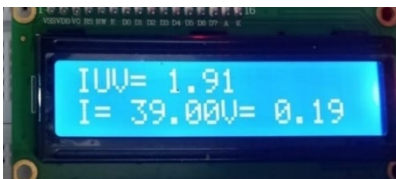
Figura 24. Medición de sensor a 0.1 m
